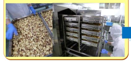
蒸したさつまいもを「真空冷却機」という 機械で一気に冷やします。
