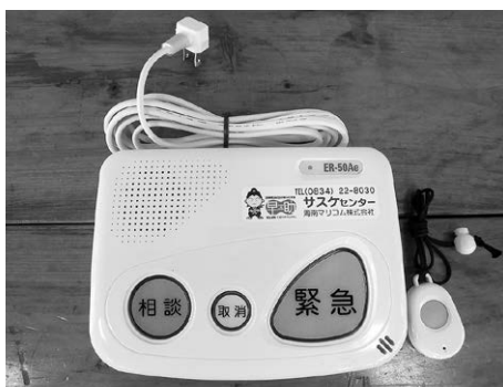
緊急通報装置
