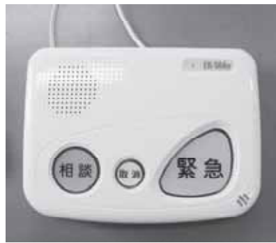
緊急通報システム
