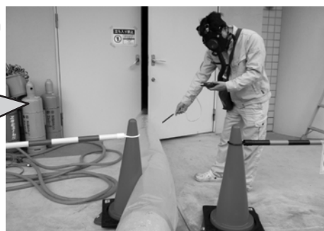
▲作業では収蔵庫に殺虫ガスを一定時間充満させたのち安全濃度を確認しながら送風機で強制排出します
