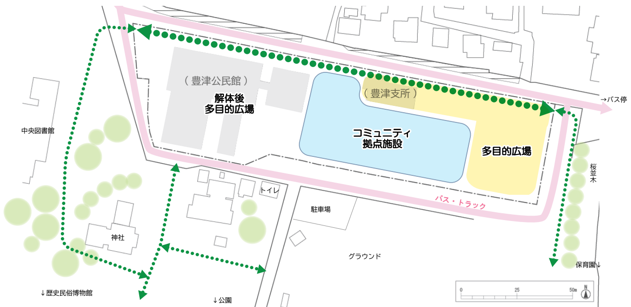
敷地中央にコミュニティ拠点施設を配置する案（建設前に既存の豊津支所を解体しない場合）
